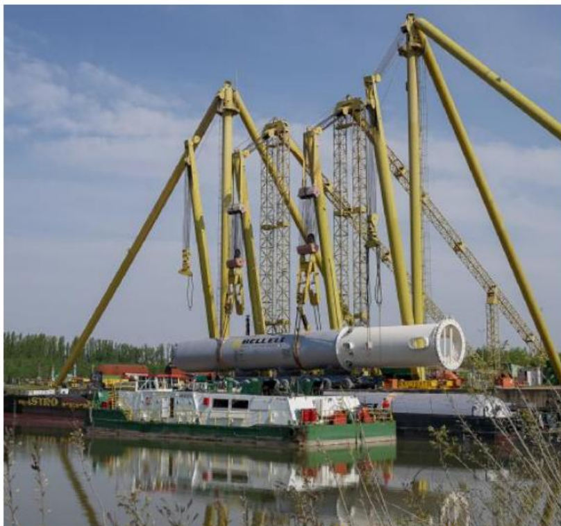
La spedizione Reattori e scambiatori vengono caricati sulla chiatta FOTOSERVIZIO DI GANGI
